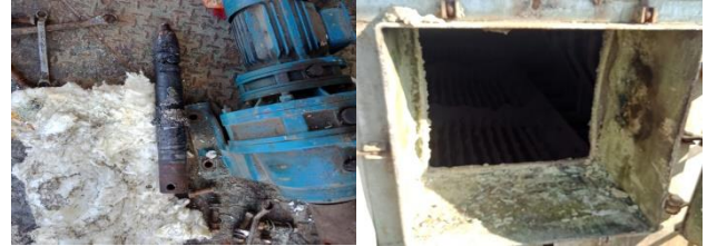
图2 阳极振打轴腐蚀后扭断
