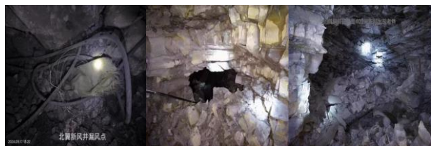
图6 新增回风斜井揭露采空区断面图
