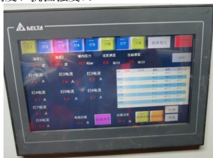
图 1 紫外光加固控制面板
