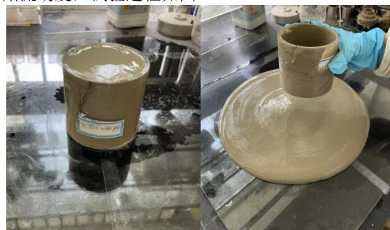
(a) 流态固化土注入圆柱筒 (b) 迅速提起圆柱筒
