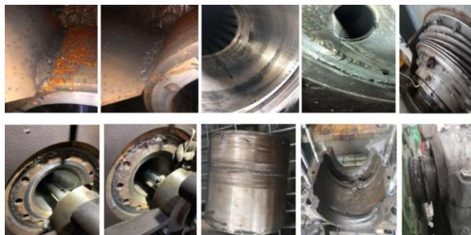
图1 真空转鼓过滤机现场故障部位图
