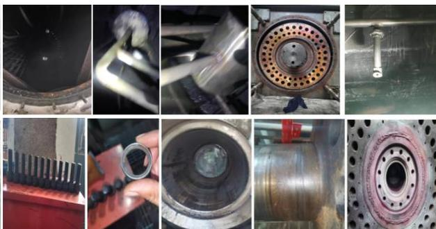
图2 真空转鼓过滤机现场故障部位图
