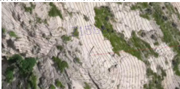
图1 针对人力无法到达的塔位,采用无人机影像成图,确定塔位
