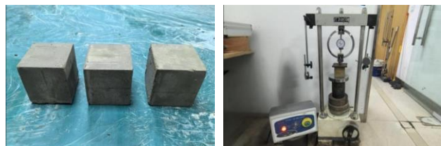
图 3 流态固化土强度测试试件与测试装置
