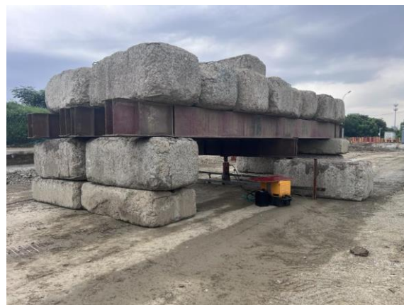
图 10 原位固化场地承载力检测(浅层平板载荷试验法)
