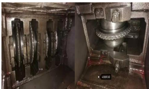
图 18 进仓后 17 英寸镶齿滚刀情况
