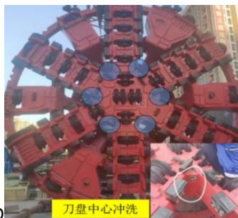
图3 刀盘配置及中心冲洗情况
