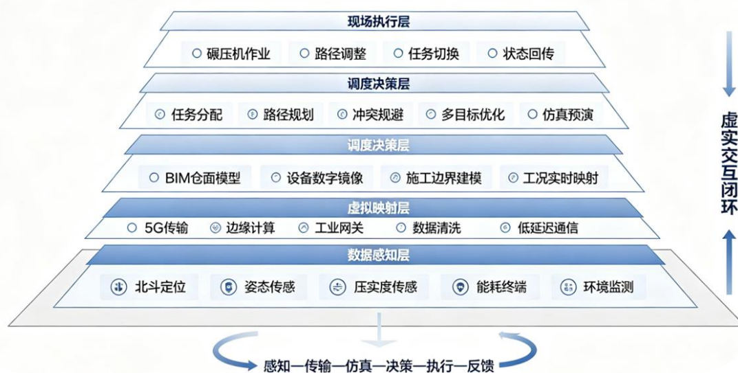
图 1 数字孪生碾压机群协同调度五层架构模型
