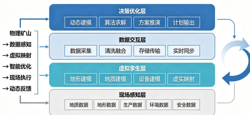
图 1 露天矿山数字孪生四层闭环体系架构图
