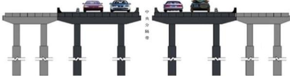
图4 桥梁上下部加宽断面图
