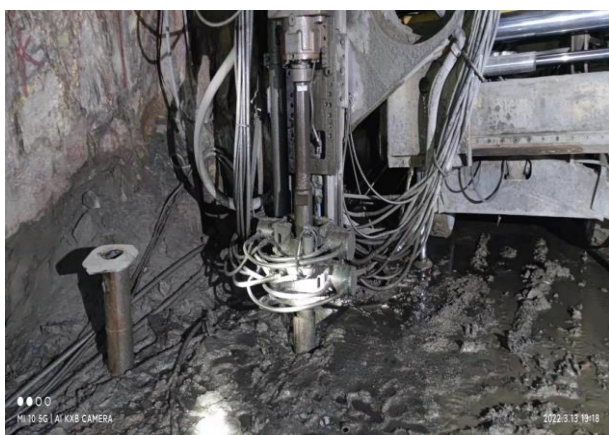
图5 Simba364 潜孔钻机深孔上向返渣
