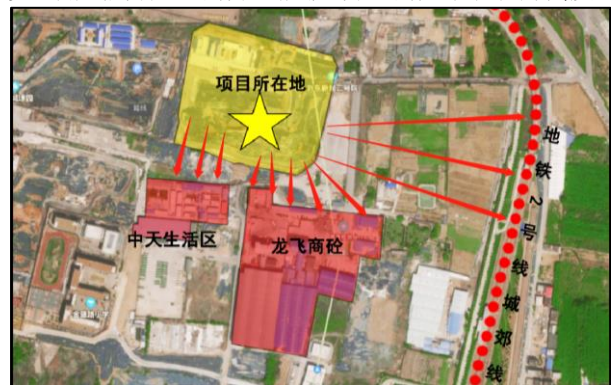
图 1 强夯施工震动范围示意图
