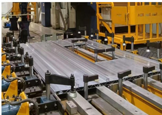
图 5 加工前侧墙的装夹
