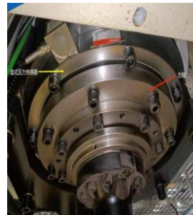
图2 盘式压力传感器与主轴的安装配合
