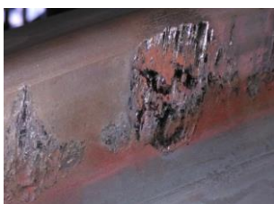
图12 内缸粘结拉伤情况
