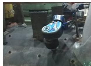
图 8 液压力矩扳手+顶开螺钉
