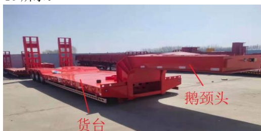
图 13 半挂平板车结构实物图
