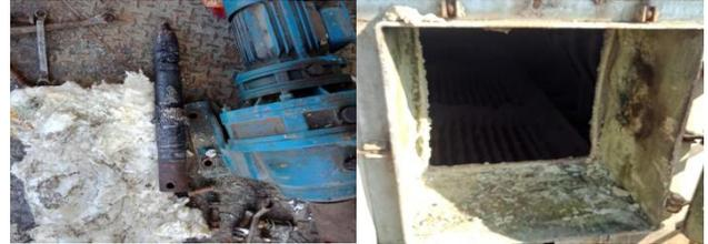
图2 阳极振打轴腐蚀后扭断
