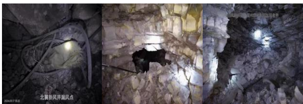
图6 新增回风斜井揭露采空区断面图
