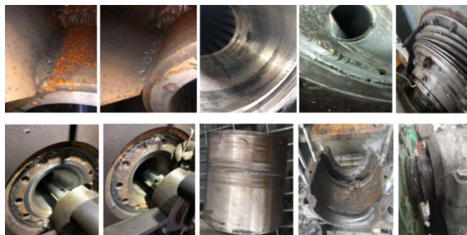
图1 真空转鼓过滤机现场故障部位图
