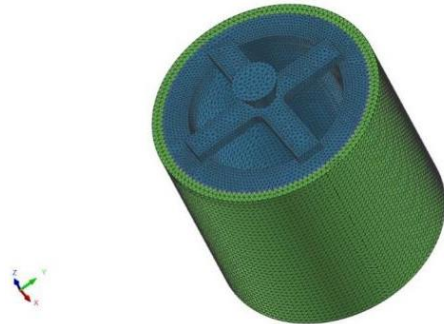
图 4 网格划分后的铝合金铸件模型
