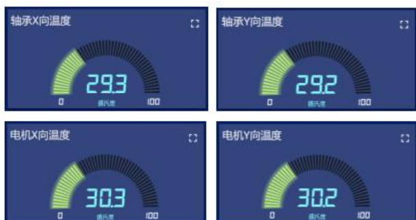
图 6 水泵轴承温度远程显示
