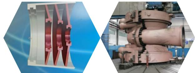
图 1 低压内缸结构示意图
