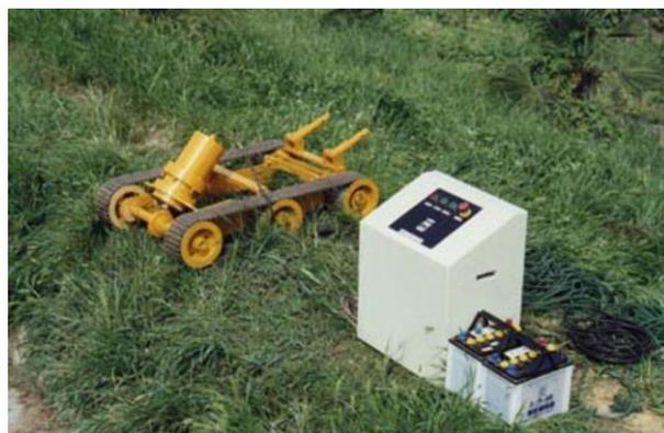
图2 水陆两用土工膜自动铺设机示意图
