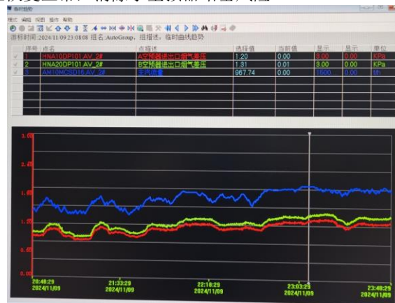
图5 使用措施10后在相仿负荷下#4炉A侧空预器差压
