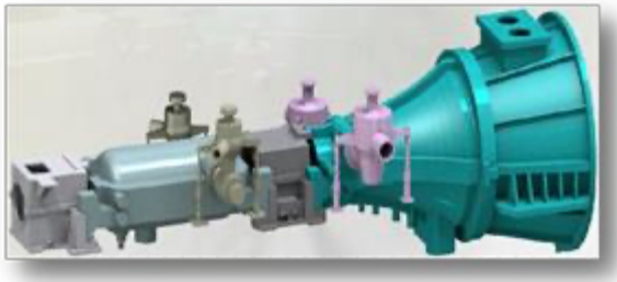
图 1 100MW 等级光热轴向排汽外形图
