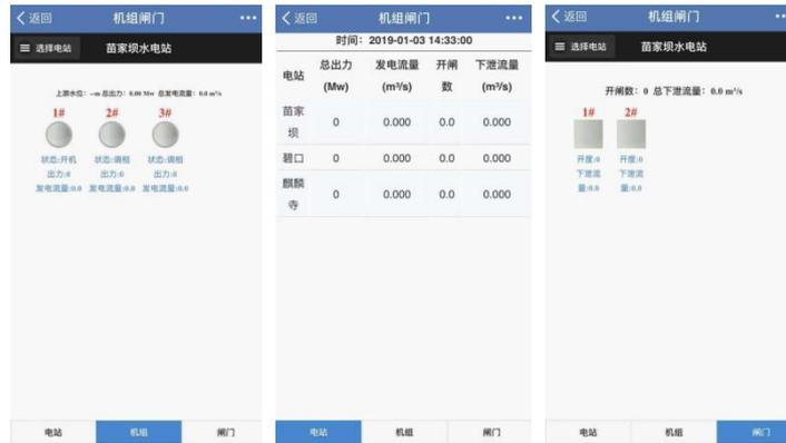
图2 电站机组闸门界面
