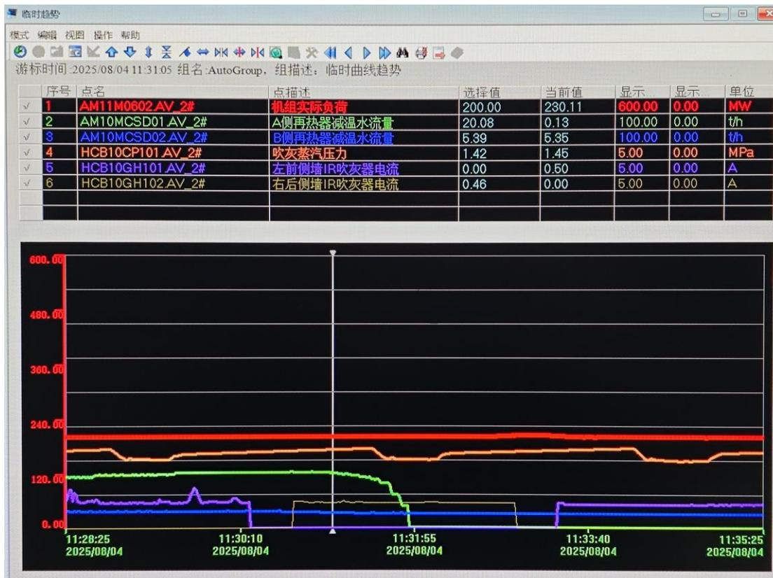
图4 200MW 负荷下炉膛吹灰后各参数趋势图
