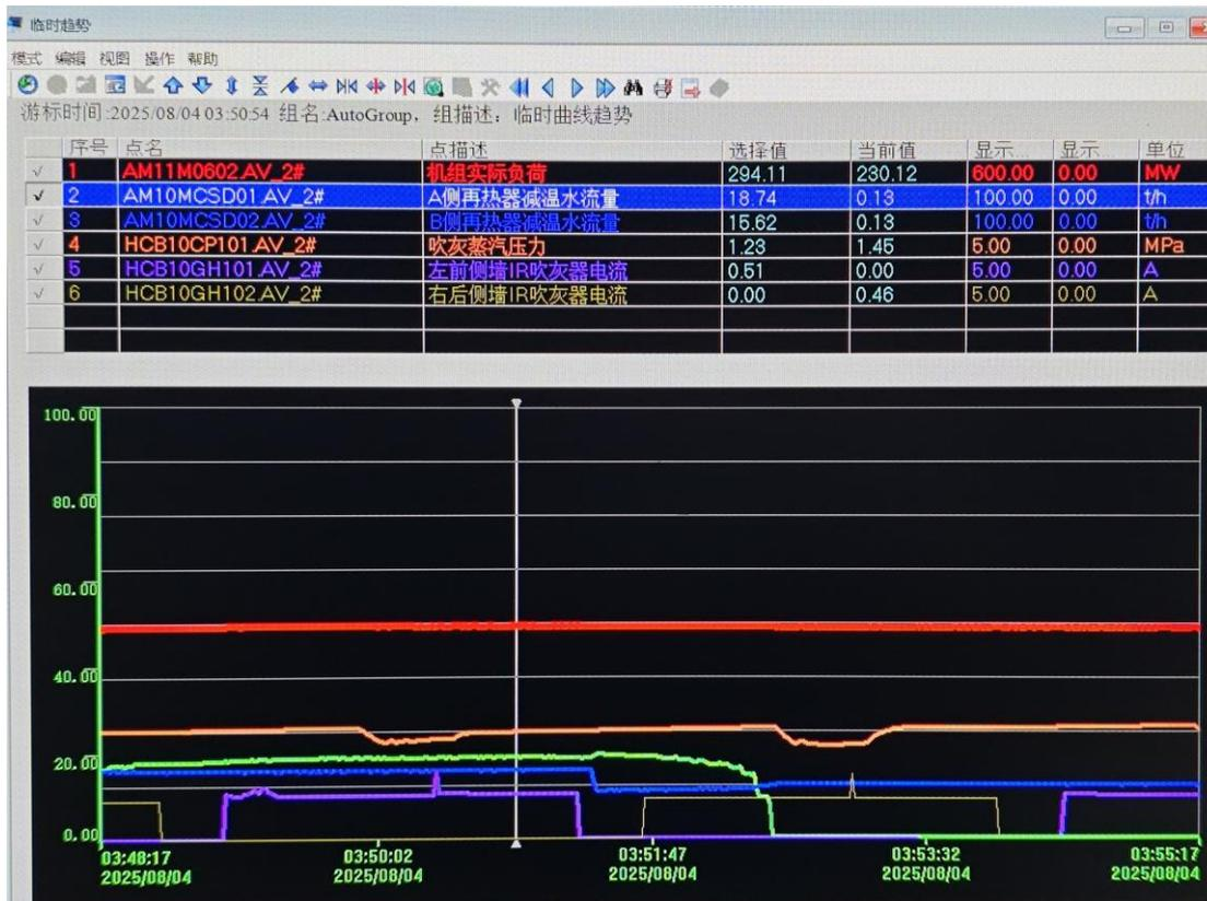
图3 295MW 负荷下炉膛吹灰后各参数趋势图
