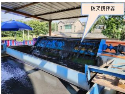
图7 泥浆与絮凝剂混凝土后进入压滤机过滤
