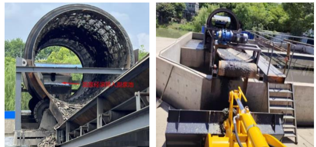
图4 固体颗粒垃圾筛除
