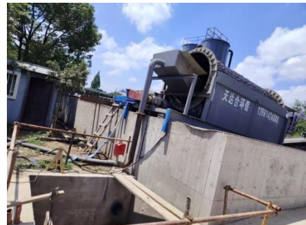
图3 淤泥吹填进滚筒筛
