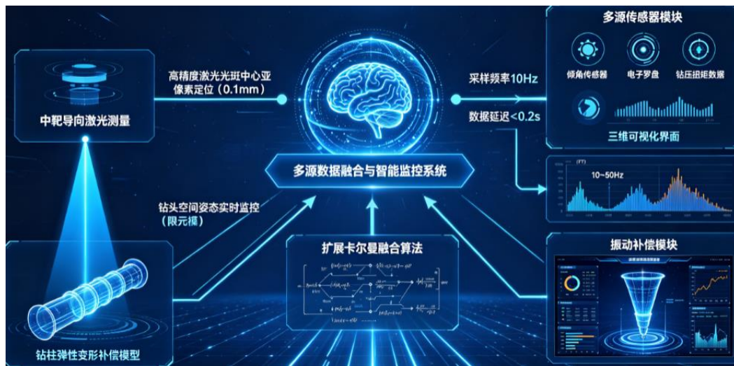
图 2 钻头空间姿态实时感知系统架构图
