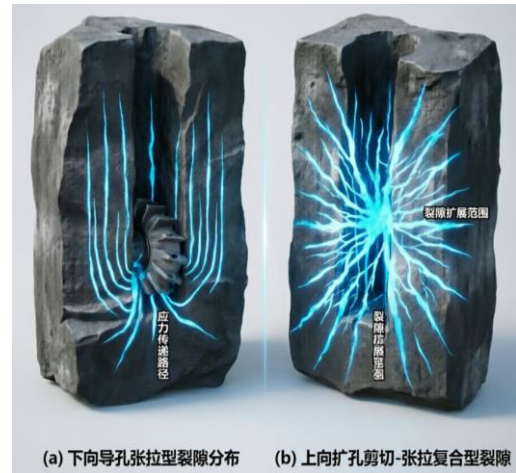
图 1 抽水蓄能竖井反井钻掘进参数正交数值试验裂隙演化对比图
