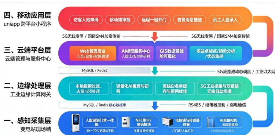
图 1 智慧门禁协同管控系统总体架构图
