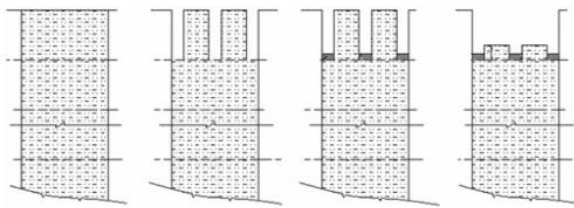
图1 地下水水泥防渗墙结构
