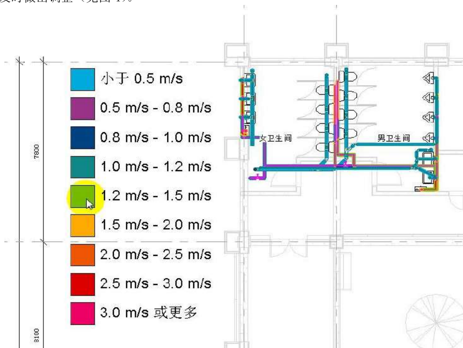
图4: 以颜色图例检查系统中管段流速
