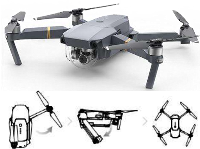
图 1 无人机新颖的折叠式设计
