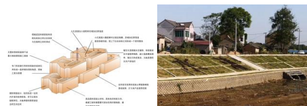
图2 生态砌块挡墙现场照片
