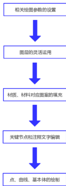
图3 水利工程施工管理中 CAD 技术的绘制流程图
