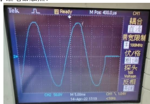
图11 在零点时刻跳闸的波形
