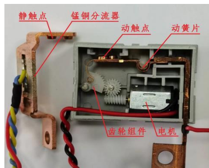
图 2 单相电机式继电器结构
