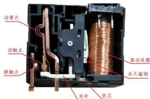
图 1 单相磁保持继电器结构
