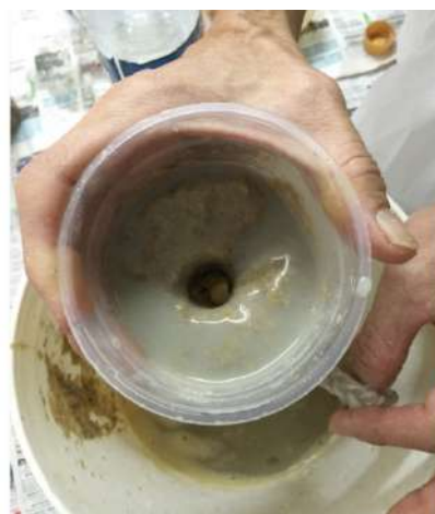
图 2.4-6 浆液改良砂土扰动试验效果
