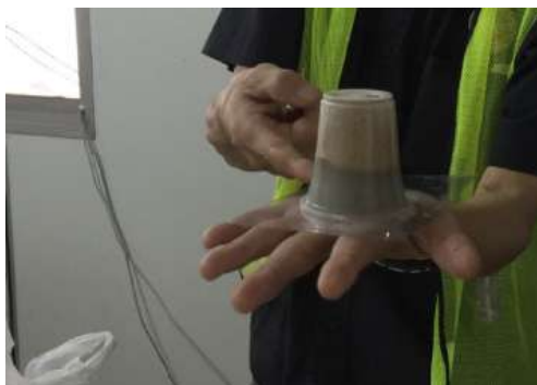
图 2.4-3 掺外加剂反转分层明显
