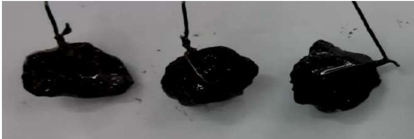
图 2-2 天然砂砾石破碎粗骨料与沥青黏附性试验结果(添加抗剥落剂)
