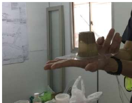
图 2.4-4 未掺外加剂的反转后砂往下掉
