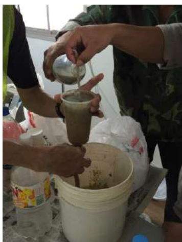
图 2.4-5 浆液改良砂土扰动试验
