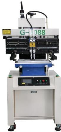
图 1 G3088 导热硅脂涂覆自动化设备
