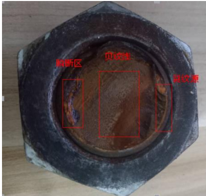
图3 叶片螺栓断裂截面
