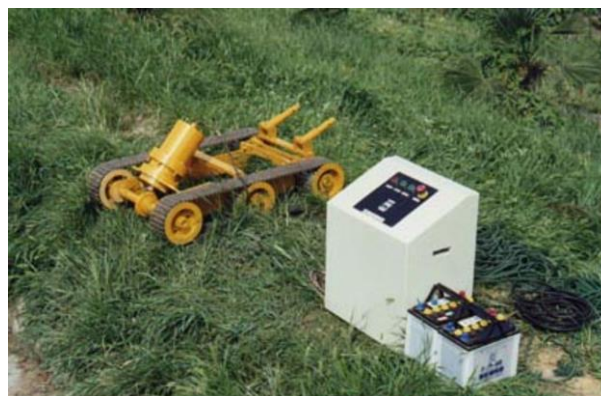
图2 水陆两用土工膜自动铺设机示意图
