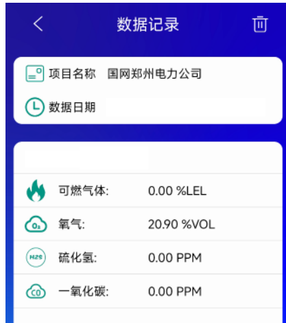
图4 可视化界面查看便携式风机启动后电缆沟内危险气体浓度情况
