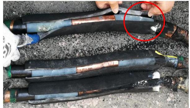
图3 外半导体剥切过长导致应力锥错位
