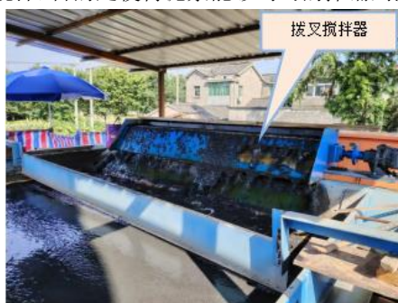
图7 泥浆与絮凝剂混凝土后进入压滤机过滤
