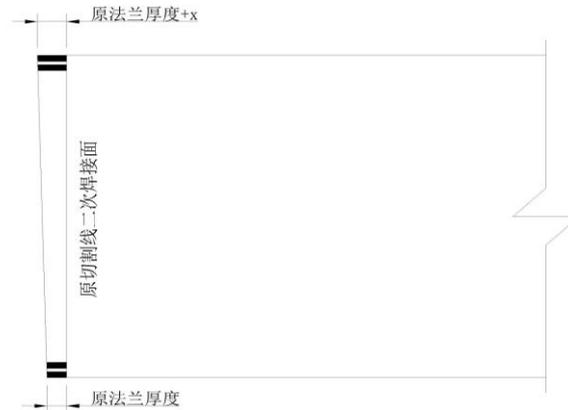
重新焊接底塔筒断面图
