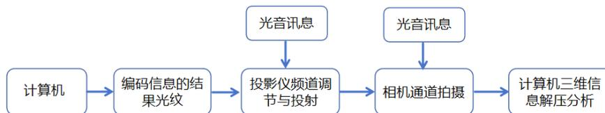
图 1 基于光学测量的计算机技术的系统过程框架图
