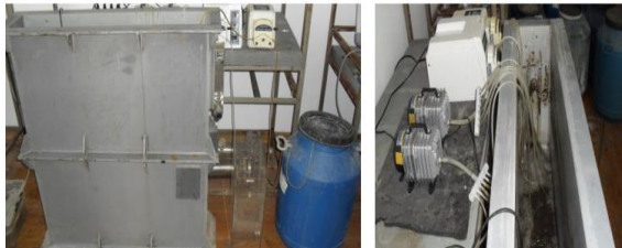
图2 MBR反应器处理猪场沼液现场试验图
