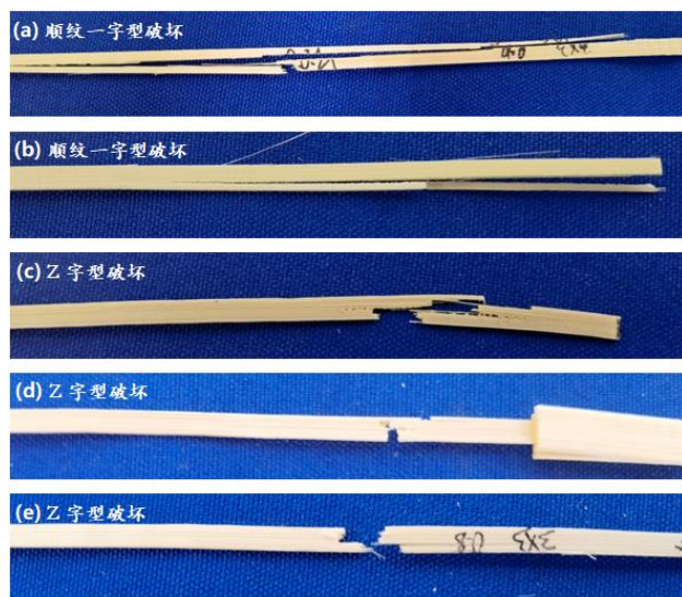
图 4 受拉杆件破坏示意图
