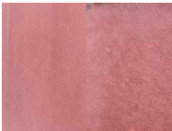
(a) 200℃测试前后气凝胶涂层的外貌
