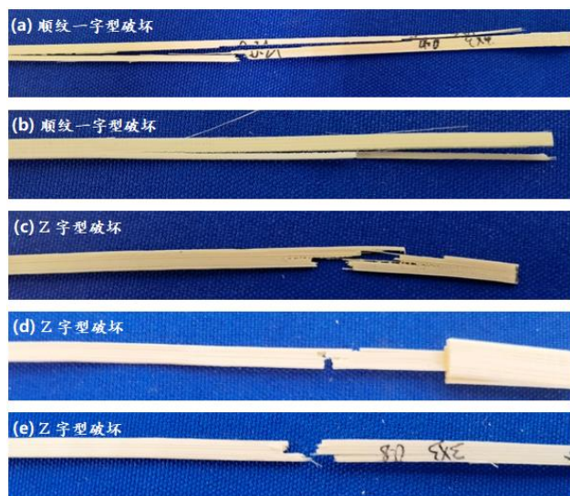
图 4 受拉杆件破坏示意图
