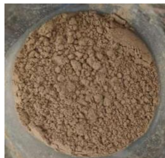
图 2 煅烧 150°C 后形态图
