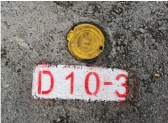
图 4 地表监测点现场布设照片
