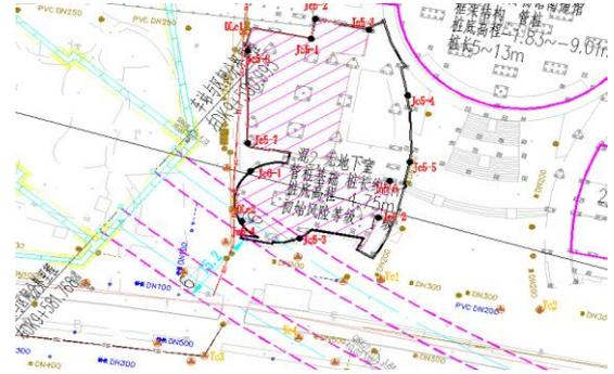
图 5 建筑物监测点平面布置图
