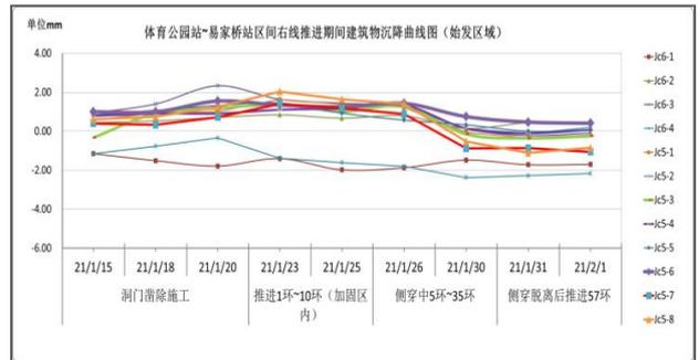
图 6 右线推进期间建筑物沉降曲线图
