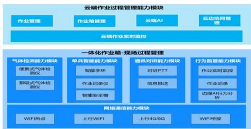
图 2 系统能力模块架构
